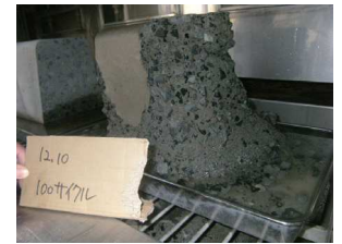
普通コンクリート
